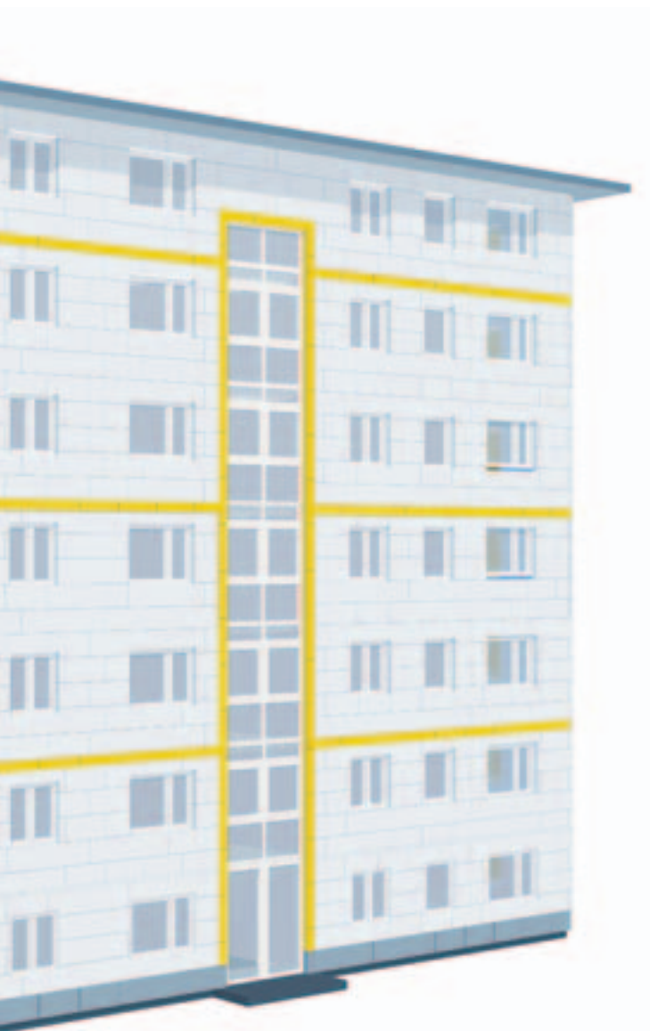
Osobna taśma hamująca rozprzestrzenianie się ognia nad każdym otworem w elewacji stanowi łatwą w montażu alternatywę.
