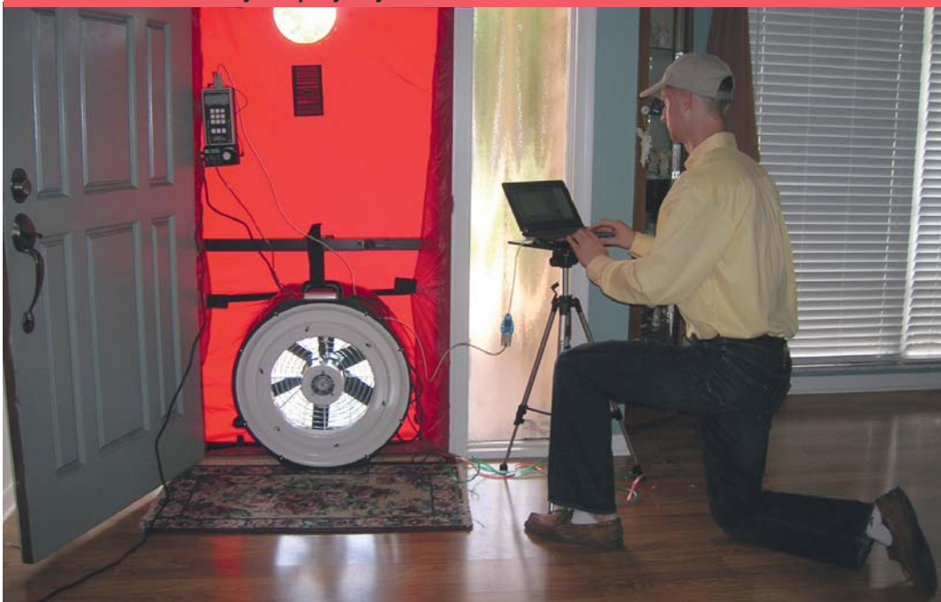
Test szczelności w budynku pasywnym – Blower Door
